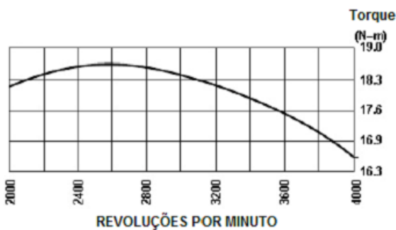
Figura 1. Curva de torque do motor Briggs & Stratton 10HP. Fonte: Sousa apud Briggs & Stratton, 1999
